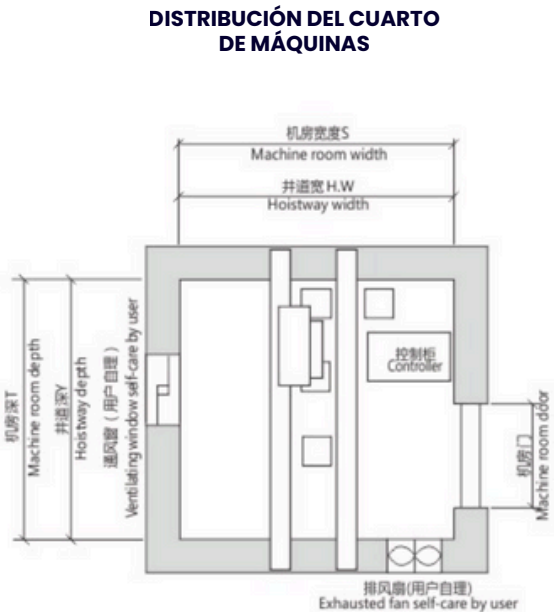
DIBUJO DE LA DISTRIBUCIÓN DE CONSTRUCCIÓN DEL ELEVADOR DE PASAJEROS CON CUARTO DE MÁQUINAS PEQUEÑO.
